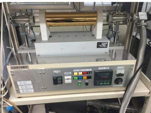
Fig. 2.2.5 卓上型均温熱処理装置
