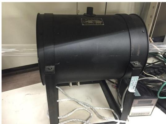
Fig. 2.1.8 管状電気炉
