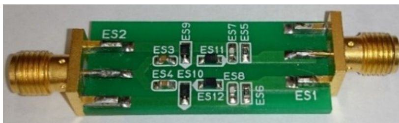
図 2.6 RF 検波回路
