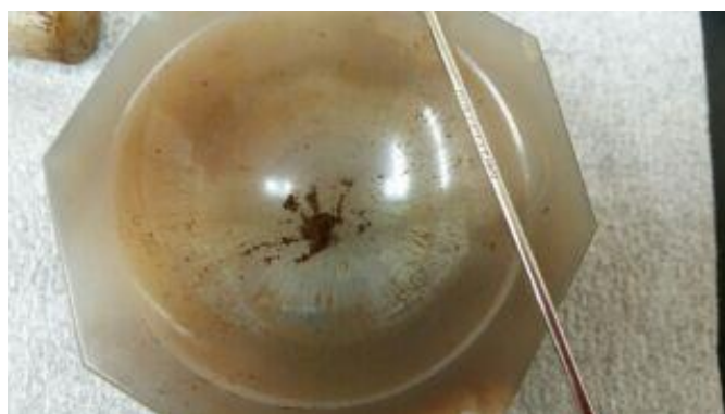
図 4-2 Sr 塩と C_{60} の混合物
