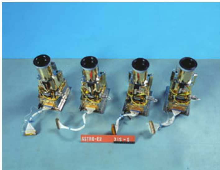
図 1.8: 「すざく」に搭載されている X 線 CCD カメラ。
