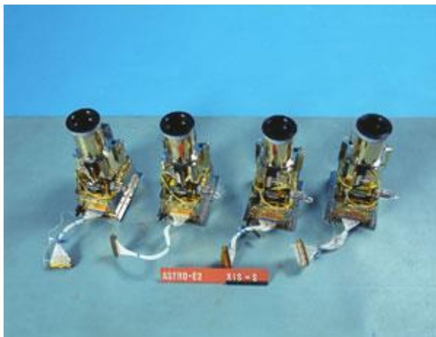
図 1.10. すざく衛星に搭載されている X 線 CCD カメラ
