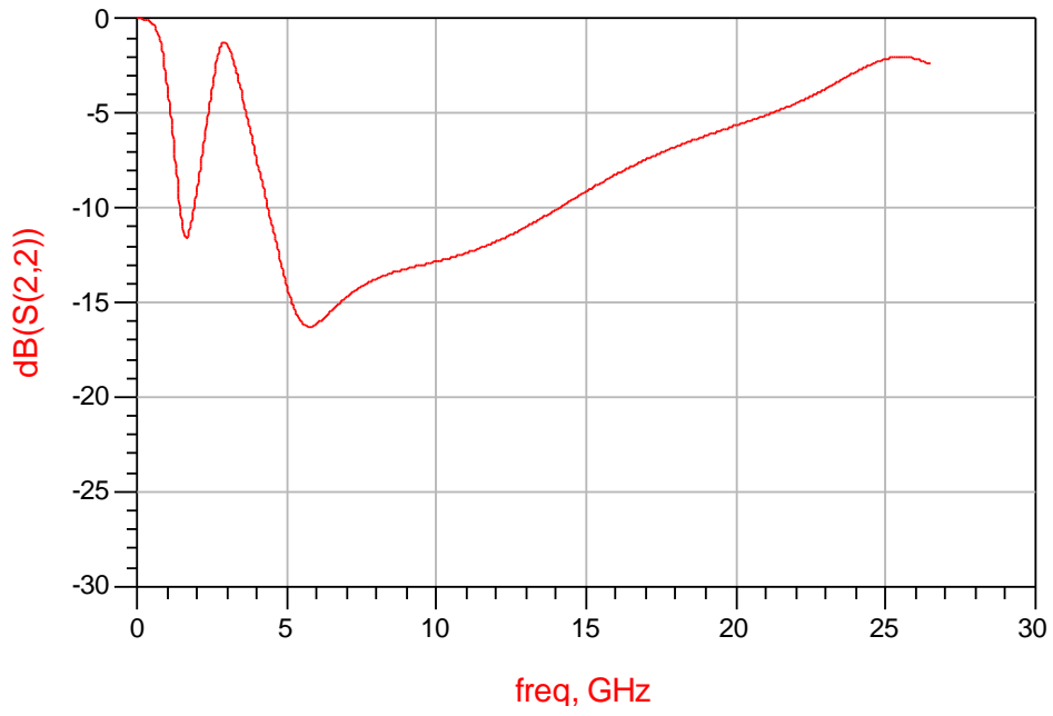
図 3.8. 低雑音増幅器 1&2 段目 S-Parameter S(2,2)
